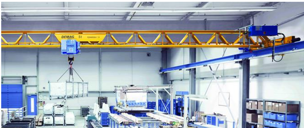
Figur 4. Exempel på v-profilkran (Bilderna hämtade från www.demag.de )
